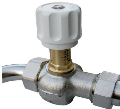
Utilizzando la curva caratteristica di funzionamento del circolatore, si individua il valore di prevalenza a cui dev'essere tarato l'intervento dalla valvola differenziale, che viene identificata pari al 15-20% della portata di progetto.
