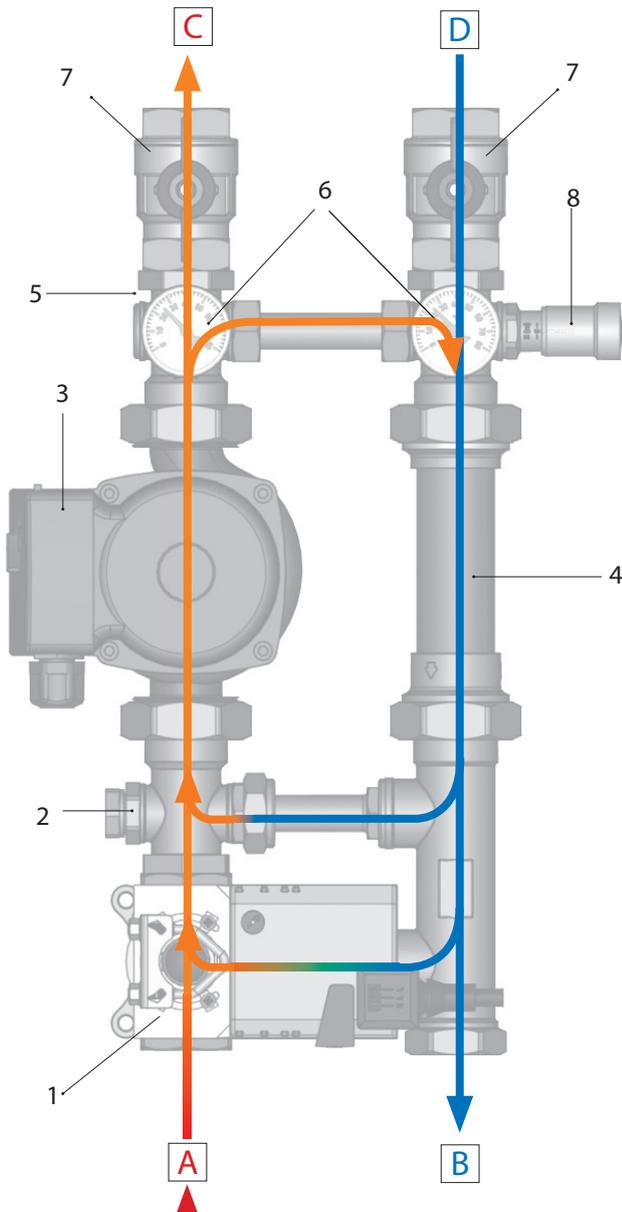
1. Valvola mix a 3 vie con servomotore 3 punti 230V (oppure 24V)
